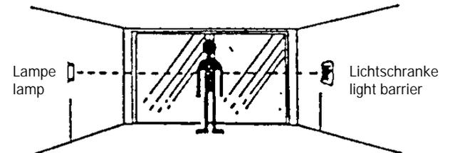
**E** Descripción de la conmutación: La barrera de luz se compone de un emisor de luz y un receptor de luz que contiene también el relé todo o nada. En estado normal el receptor se ilumina por el emisor. Cuando se interrumpe el rayo de luz, el relé conmuta y se pueden mandar diferentes emisores de señales (lámparas, zumbadores, timbres, etc.).
